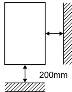
\*Nota: i prodotti dotati di sensore a infrarossi devono essere installati con una distanza minima di 200 mm tra il sensore e qualsiasi oggetto solido o superficie riflettente.
