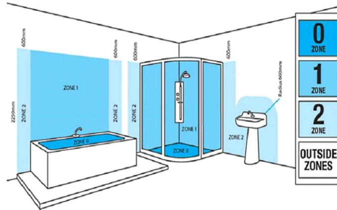
Tutte le installazioni devono rispettare le linee guida basate su un concetto zonale e devono essere seguite per garantire l'installazione sicura degli apparecchi elettrici nel bagno. Queste norme si applicano solo agli impianti domestici. Le installazioni devono essere effettuate in conformità con le attuali normative di cablaggio IEE e le normative edilizie pertinenti. Questo prodotto ha un grado di protezione IP44 ed è adatto per l'installazione in ZONA 2 e Zona Esterna
