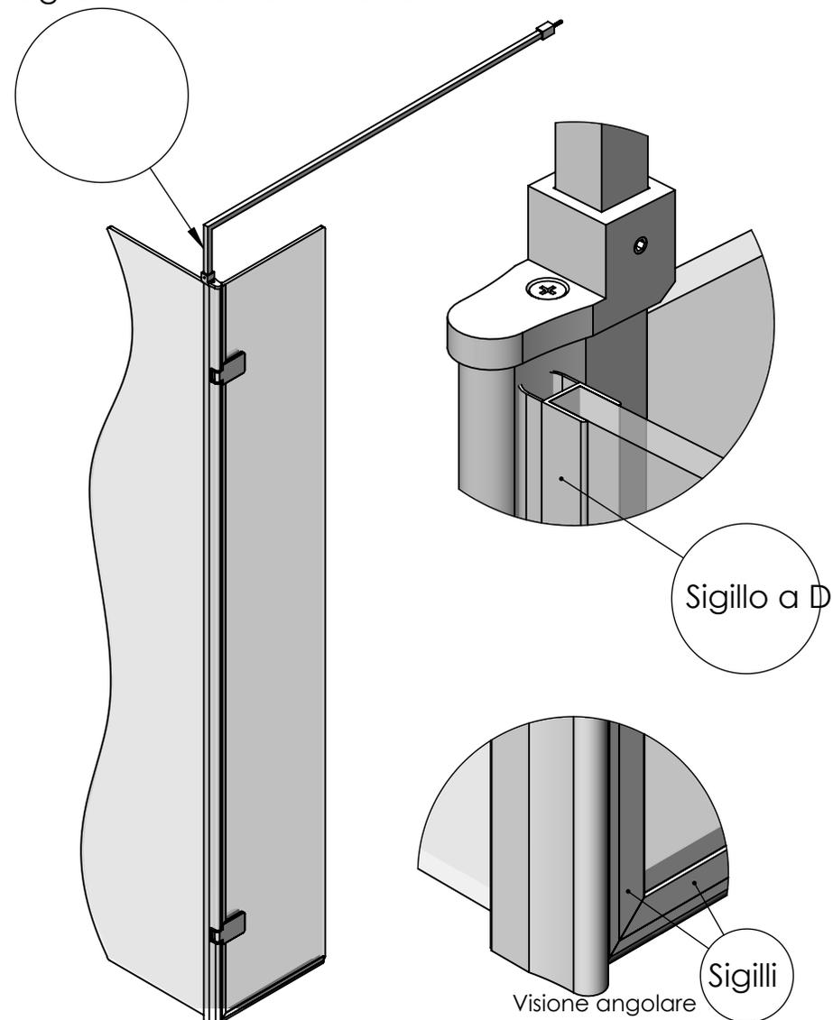
8. Montare la guarnizione a forma di "D" sul vetro della cerniera assicurandosi che sia a tenuta sul profilo di alluminio.
