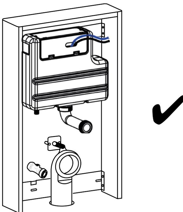
**Installazione del tubo di alimentazione dell'acqua:**
