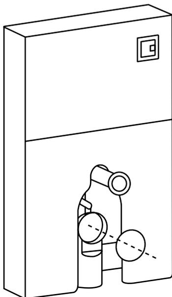
Installare il tubo di gomma nel tubo di scarico a 90°
