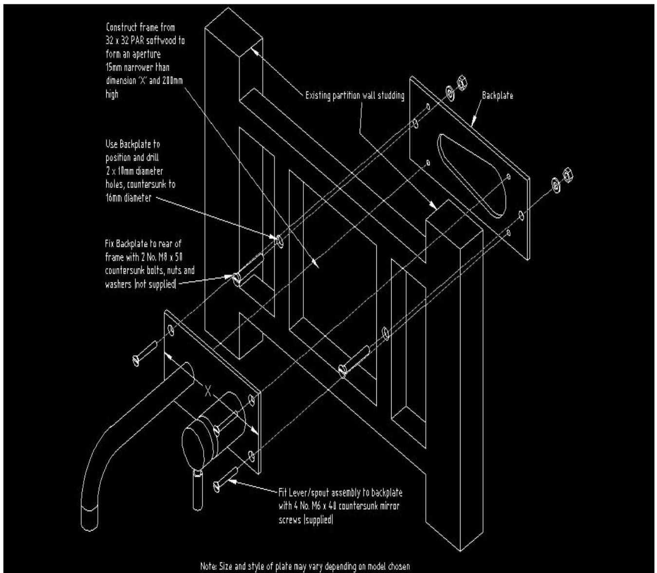
Costruire il marco di 32x 32 PAR di legno tenero per formare una apertura di 15mm più stretta che le dimensioni "X" e di 200mm di altezza
